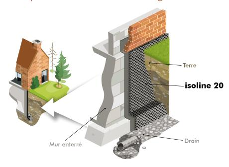
Utilisé **verticalement** avec la face structurée orientée vers un mur enterré, l'**isoline 20** assurera une séparation entre les terres et la paroi. La protection mécanique et la ventilation ainsi créée permetteront de garder des caves ou garages enterrés parfaitement secs à long terme.
