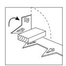
Vous pouvez plier les bordures à l'aide d'un établi (en cas d'utilisation d'un étau à vis, prendre des blocs en bois pour éviter les rayures) ou d'un bloc de bois. Pliez les bordures à la main pour créer un cercle ou une forme libre.
