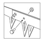
Vous pouvez si vous le souhaitez fixer les parties qui dépassent en y perçant un trou et en fixant les parties les unes aux autres à l'aide d'un boulon et d'un écrou. Utilisez pour la version noire une couche primaire afin de protéger les matériaux contre la corrosion. Découvrez toute notre gamme sur : **www.matgeco.be**
