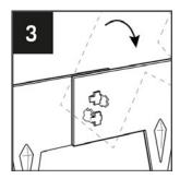
Edgi 75 se pose très simplement et rapidement. Chaque bordure peut être attachée à une autre grâce au système d'emboitement (1), aucun outil n'est nécessaire. Les deux bordures sont simplement superposées à leur extrémitées (2). Elles sont ensuite fixées l'une à l'autre par un mouvement rotatif (3).
