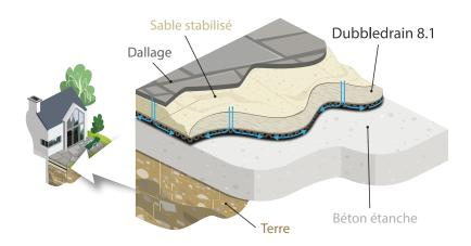
Le DubbleDrain 8.1 pourra être déroulé directement sur un béton étanche, géotextile vers le haut. Il sera ensuite recouvert d'un sable stabilisé en vue de la réalisation de pavages ou de dallages. En cas d'infiltration d'eau sous le dallage au travers du stabilisé, elle pourra être évacuée grâce au DubbleDrain.
