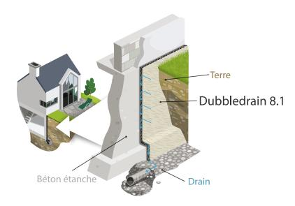
Le DubbleDrain 8.1 sera utilisé verticalement le long d'un béton étanche. La face structurée sans géotextile sera orientée vers le mur. Le géotextile se trouvera du côté terre afin de diminuer la pression hydrostatique contre la paroi. Les eaux sont amenées par l'intermédiaire du DubbleDrain 8.1 vers un tuyau de drainage situé au bas du mur enterré.
