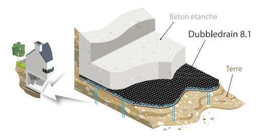
Pour limiter les pressions hydrostatiques sous une dalle de fondation, le DubbleDrain 8.1 pourra être déroulé à même la terre, géotextile vers le bas. Le radier sera ensuite réalisé sur la membrane.
